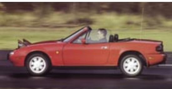
Mazda MX-5 při jízdě s vyklopenými světlomety, které pak částečně narušují uhlazené linie karoserie. Vyklopění i sklopení je prováděno elektromagneticky.
