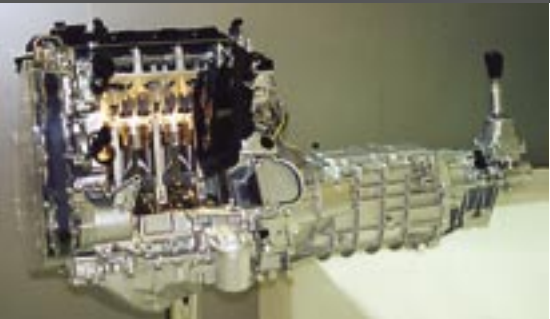
Motor v částečném řezu – v přední části dobře viditelný pohon obou vačkových hřídelí ozubeným řemenem. Pozoruhodné jsou i rozměry převodovky (vzhledem k velikosti motoru), která má svůj původ v typu RX-7 (s Wankelovým motorem) a u typu MX-5 do určité míry přebírá i nosnou funkci částí podvozku.
