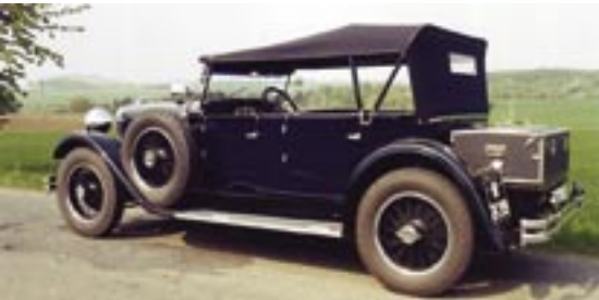
Charakteristickými znaky karosérie phaeton (též tourer) je jednoduchá sklopná střecha a dveře bez okenních rámců – postranní okna jsou samostatná a ke karosérii se podle potřeby nasazují a připevňují.
